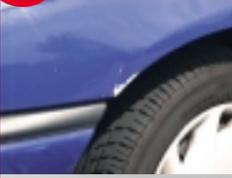
Am vorderen Kotflügel ist ein Lackschaden. Der Kotflügel muss neu lackiert werden.
